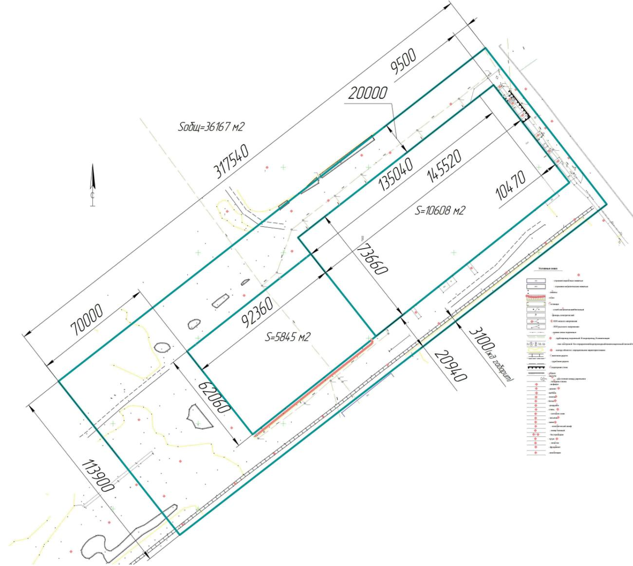
План производственного здания 2 (В:651 на схеме расположения зданий на уч 314; S≈21тыс.м<sup>2</sup>; высота до опор подкрановых балок 7,5м., до ферм – 14,4м.)
